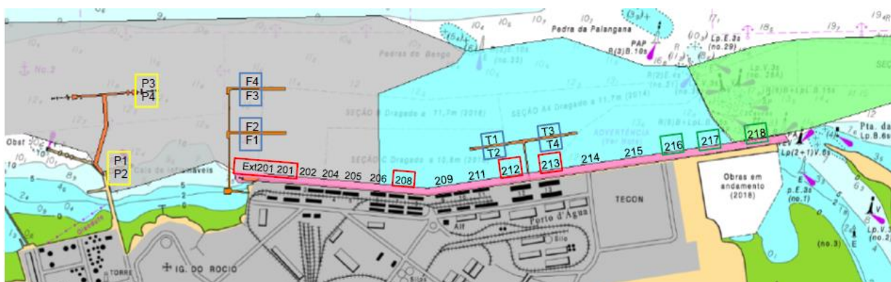
Figura 1 Projeção de ampliação da estrutura de atracação do porto de Paranaguá (Pier “T”, Pier “F” e Pier “L”)
